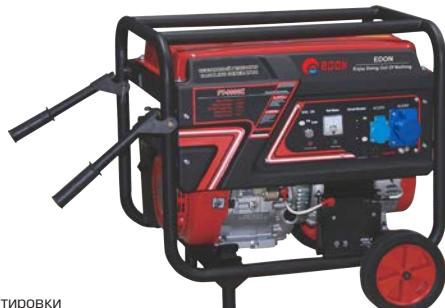
**Колеса** для удобства транспортировки**Запуск** – ручной/электрический стартерВоздушное **охлаждение**Розетка 220 В с вилкой (2 шт) **в комплекте****Блок AVR** – автоматическая регулировка уровня выходного напряжения**Комплект** проводов постоянного тока
